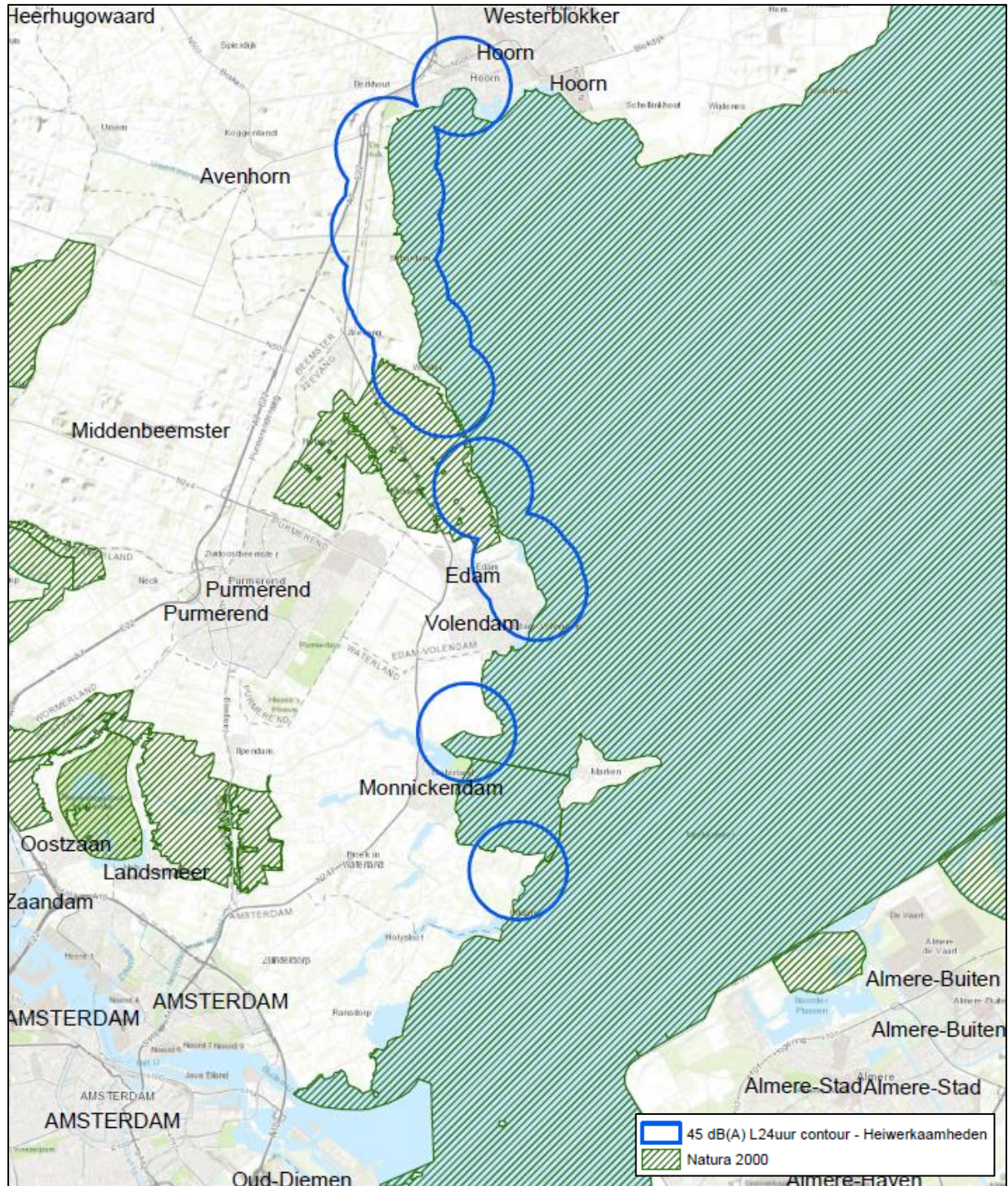
Afbeelding 19: Geluidscontour 45 dB(A)-contour van de heiwerkzaamheden.
